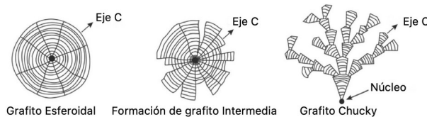
Figura 3. Crecimiento de formas de grafito esférico, intermedio y grueso [7].
